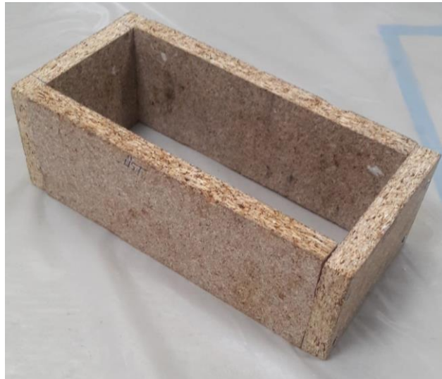
Şekil 5.15 Dikdörtgen ahşap kalıp
