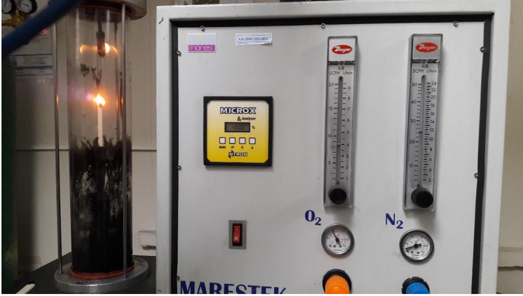
Şekil 2.11 Limit oksijen indeksinin tayini
