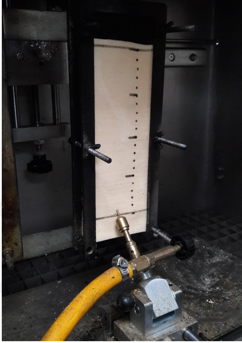
Şekil 2.9 Küçük alev testi
