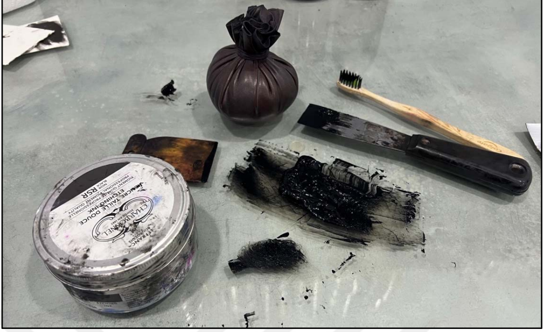
Şekil 4.10 Kalıba Boya Verme Aşamasında Kullanılan Malzemeler
