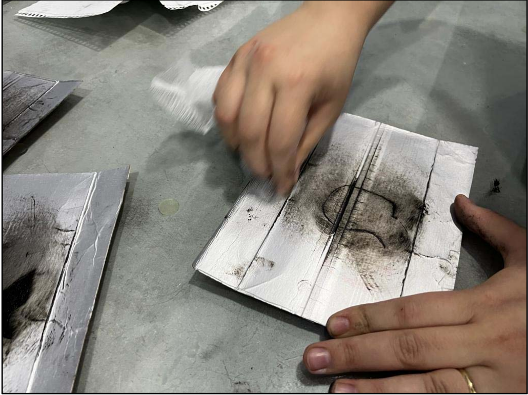
Şekil 4.11 Kalıptan Fazla Boyanın Temizlenme Aşaması
