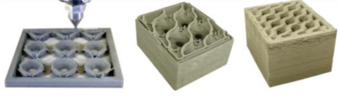
Şekil 2.4. Çöküş (Solda), Kısmi Hücre Çöküşü (Ortadaki Fotoğraf) ve Mükemmel Şekilde Basılabilir Tuğla (Sağda) (Sangiorgio et al, 2022)
