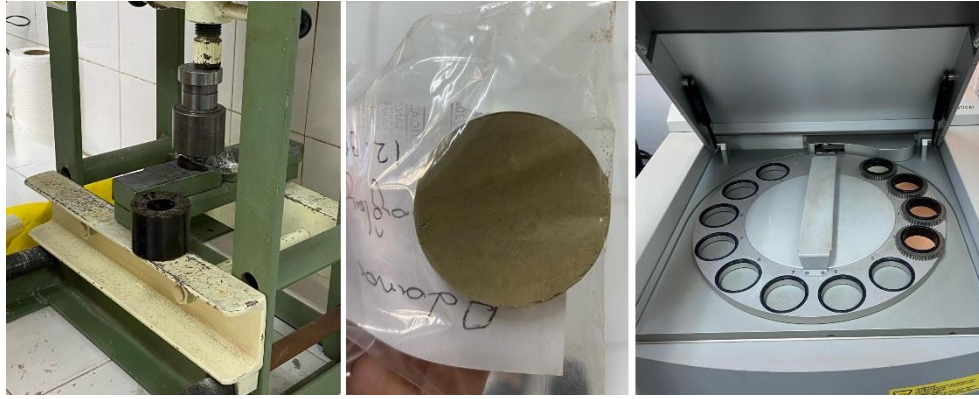
Şekil 4.17 XRF Analiz Süreci
