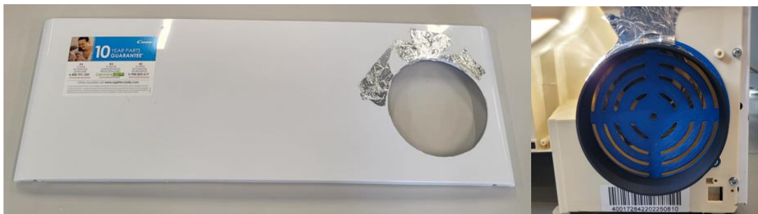
Şekil 8.4 : Izgarası kesilmiş tekmelik ve kanalı üzerinde olan soğutma kanalı ızgarası
