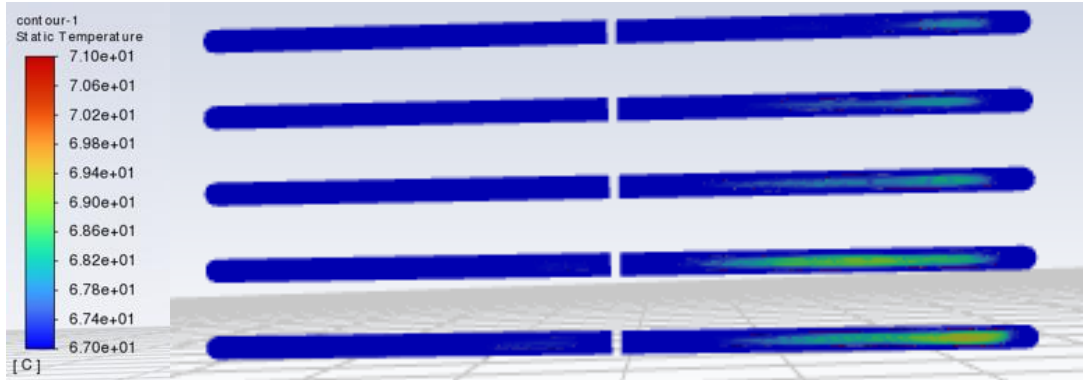
Şekil 7.34 : Modifiye makinenin kurutma havasının kondanser çıkışındaki sıcaklık dağılımı
