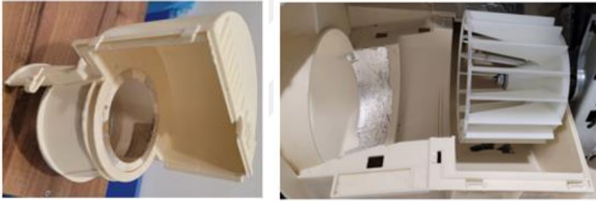
Şekil 3.7 : Fan kapağı ve fan kanalı
