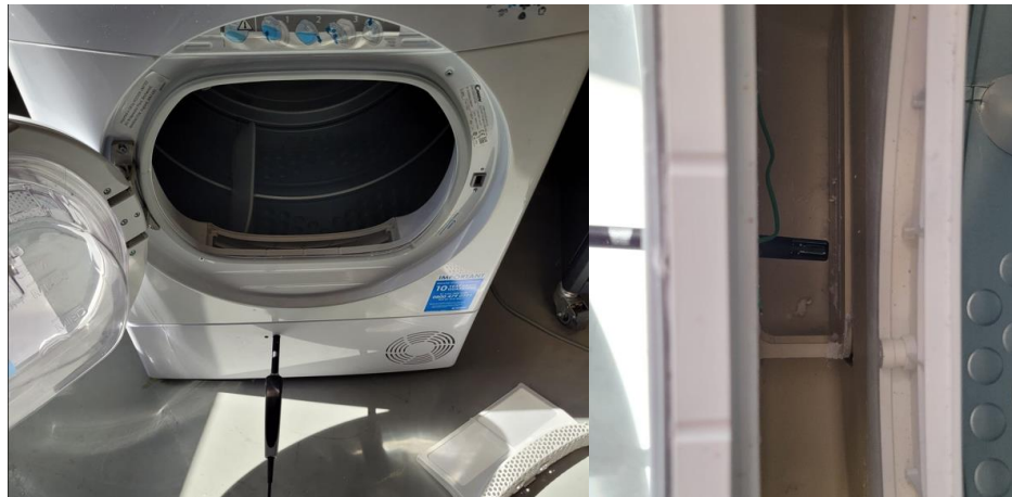
Şekil 5.16 : Kondenser kanallarının giriş bölgesine kanal açılarak kurutma havasının kanala giriş yapmadan önceki bağıl nem miktarı ölçülmüştür
