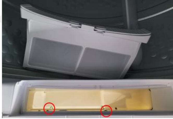
Şekil 5.12 : Kurutma havasının kondenser kanallarına girmeden önceki sıcaklığının ölçümü için filtrenin altına yerleştirilen termokupllar
