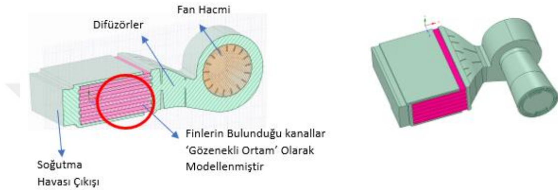
Şekil 7.5 : Soğutma sisteminin HAD analizi için oluşturulan akış hacminin kesit görseli ve tam görseli
