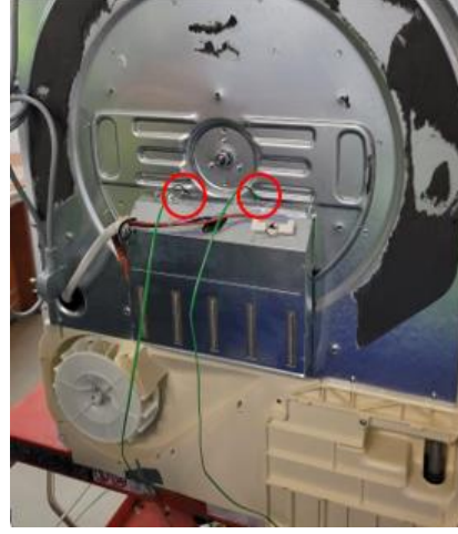
Şekil 5.11 : Isıtıcı sonrası-tambur girişi bölgesine yerleştirilen termokupllar
