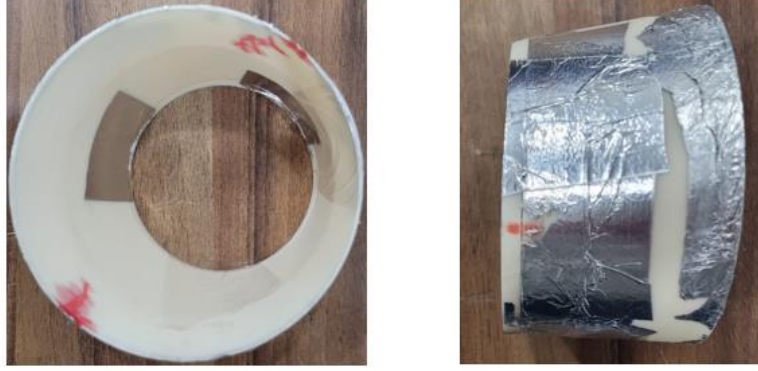
Şekil 7.16 : İyileştirilmiş tasarım için 3D yazıcıda üretilen parça
