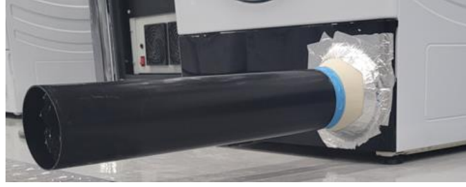
Şekil 5.4 : Debi ölçümü için kullanılan tekmeliğin makine üzerindeki görseli
