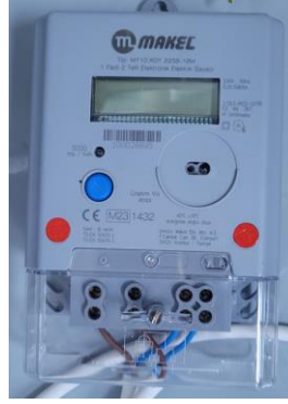
Şekil 5.6 : Elektrik tüketiminin karşılaştırılması için kullanılan elektrik sayacı
