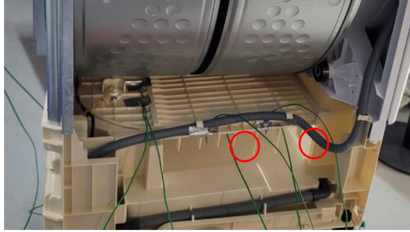
Şekil 5.15 : Kondenser sonrası soğutma havasının sıcaklık ölçümü için yerleştirilen termokupllar
