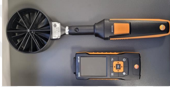
Şekil 5.2 : Testo marka anemometre ve uzaktan bağlantılı veri okuyucu
