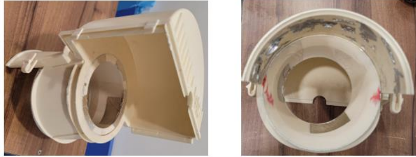
Şekil 7.17 : 3D yazıcıda üretilen parçanın mevcut fan kapağına montajlanmış halinin görselleri
