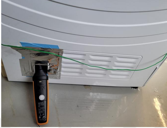
Şekil 5.17 : Kondenser kanallarının çıkış bölgesine kanal açılarak kurutma havasının kanaldan çıkış yaptığı bölgedeki bağıl nem miktarı ölçülmüştür
