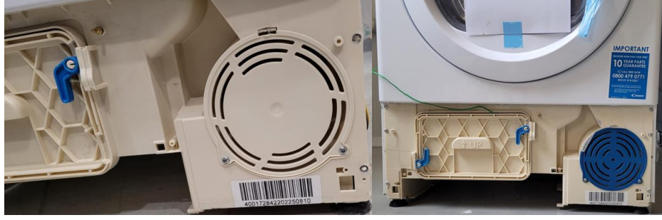
Şekil 8.2 : Mevcut ve modifiye edilmiş soğutma kanalı ızgarası
