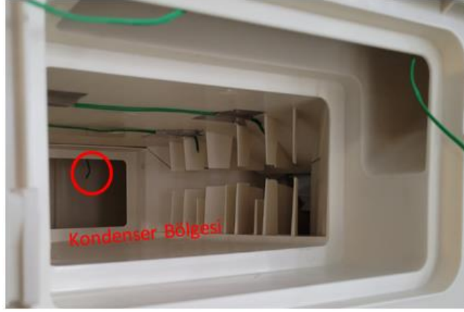
Şekil 5.13 : Kurutma havasının kondenser sonrası sıcaklığının ölçümü için yerleştirilen termokupl
