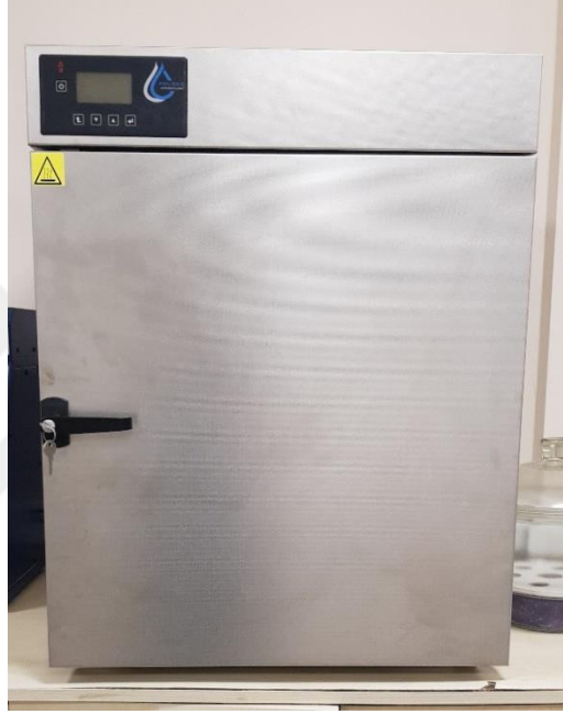
Şekil 3.2. Hammadde kurutma amaçlı kullanılan etüv
