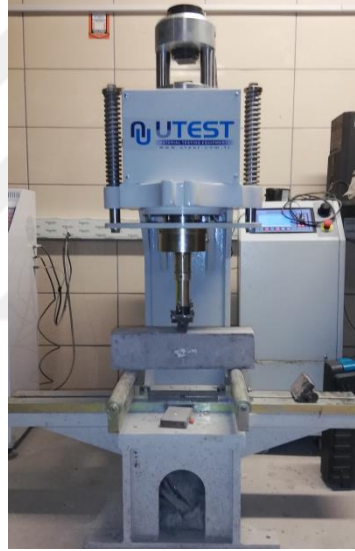
Şekil 3.28. Numunelere eğilme dayanımı deneyi yapılması
