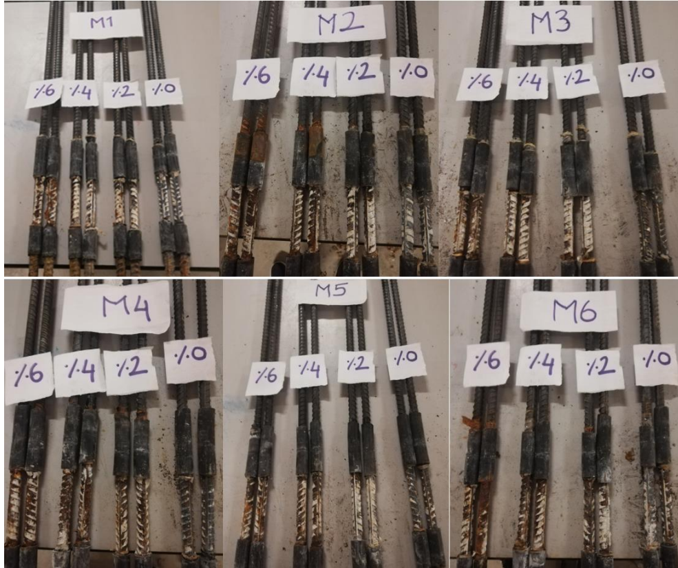
Şekil 4.38. M1-M6 arası serilerin pullout deneyi sonrası donatı görselleri
