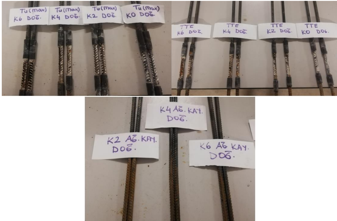
Şekil 4.40. Doğrulama kodlu serilerin pullout deneyi sonrası donatı görselleri
