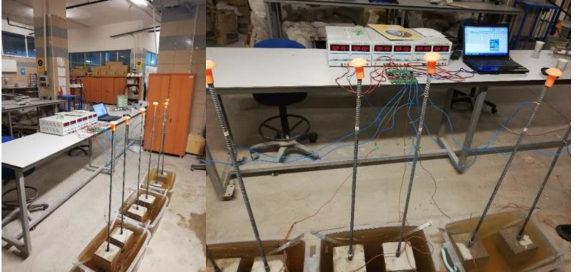
Şekil 3.32. Hızlandırılmış korozyon deneyinin uygulanması
