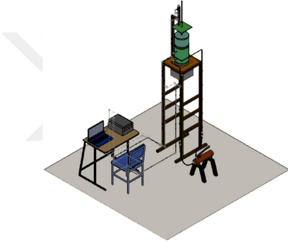
Şekil 3.33. Pullout deney düzeneği
