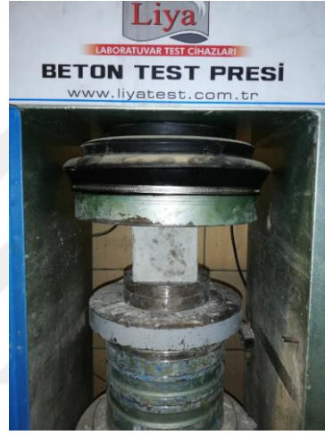
Şekil 3.26. Numune üzerinde basınç dayanım testinin uygulanışı
