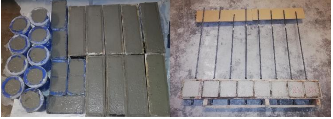
Şekil 3.19. Hazırlanan karışımların kalıplara yerleştirilmesi
