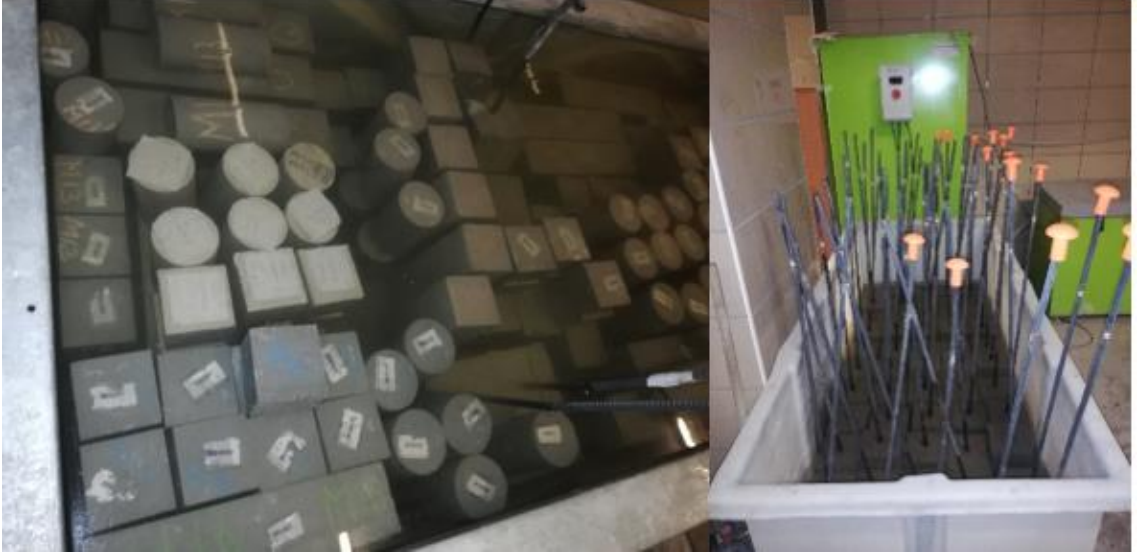
Şekil 3.20. Numunelere kür işlemi uygulanması
