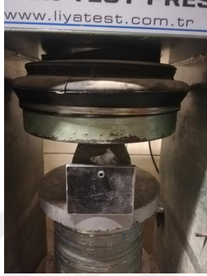
Şekil 3.29. Numunelere yarmada çekme dayanımı deneyi yapılması
