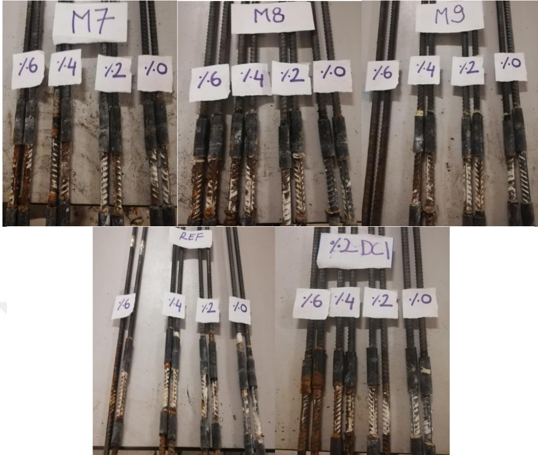
Şekil 4.39. M7-M9, REF ve %2 DCI kodlu serilerin pullout deneyi sonrası donatı görselleri
