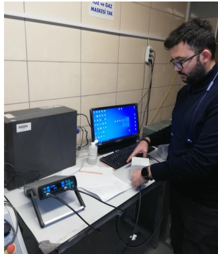
Şekil 3.27. Numunelere ultra ses geçiş hızı deneyi yapılması
