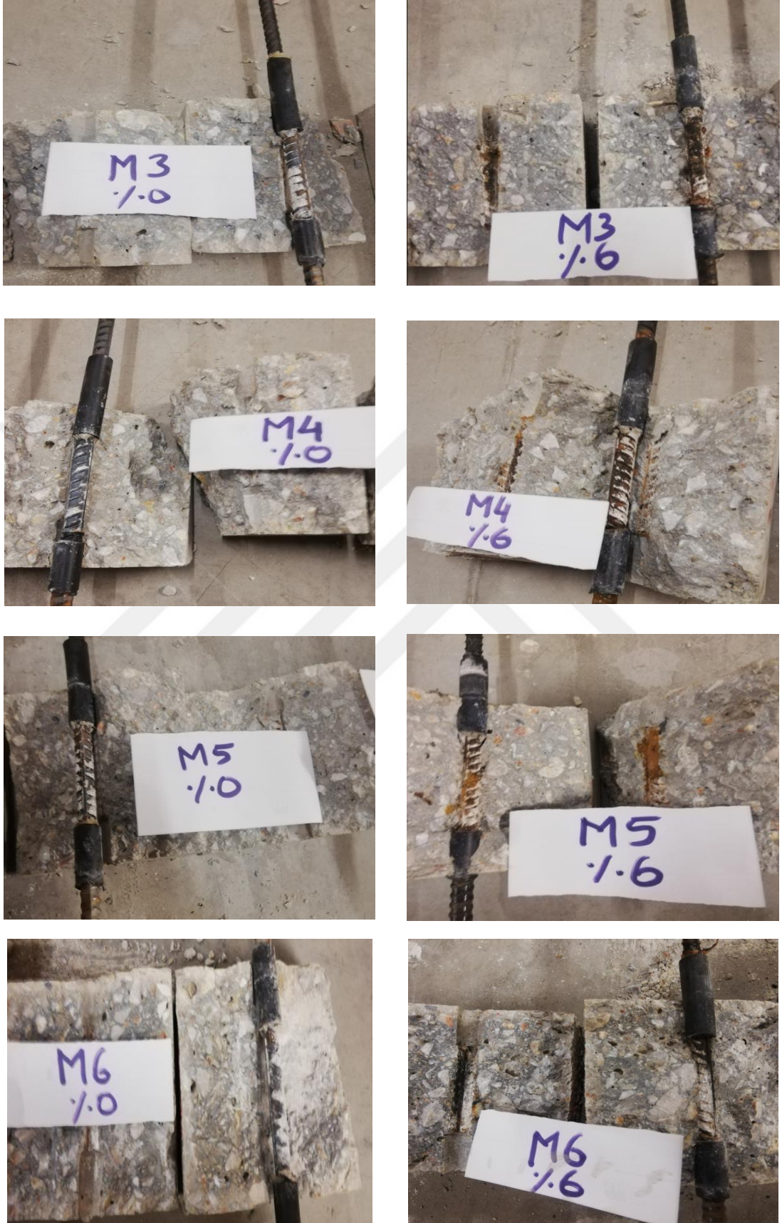
Şekil 4.28. M3, M4, M5 ve M6 serilerinin K0 ve K6 durumlarında pullout deney sonrası görselleri
