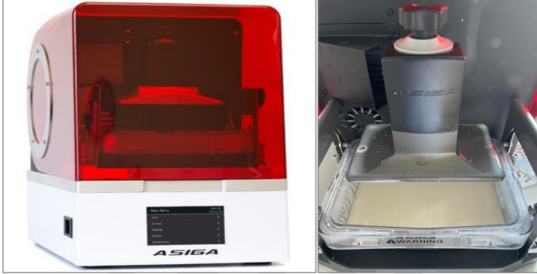
Resim 3.10. Eklemeli CAD/CAM grubunun ürettiği cihaz ve hazneye fotopolimer reçine yerleştirilmiş görüntüsü
