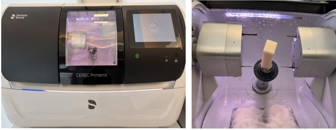
Resim 3.7. Frezeleme cihazı ve cihaza blok yerleştirilmesi
