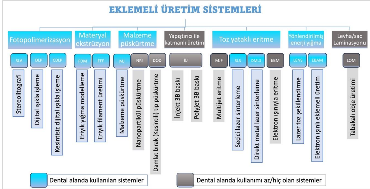
Şekil 2.5. Eklemeli üretim yöntemlerinden mavi ile belirtilenler dental alanda sık kullanılan yöntemlerken, gri renk dental uygulaması olmayan veya daha az olan yöntemleri temsil eder [60]
