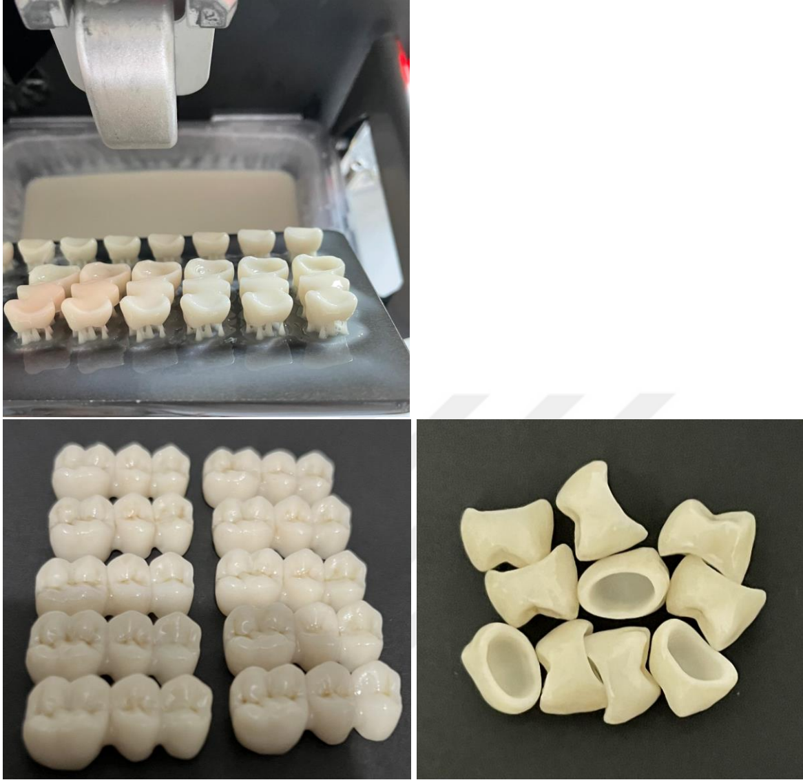
Resim 3.12. Eklemeli yöntemle üretilen geçici kron ve köprü restorasyonların üretimi, destek yapıların uzaklaştırılması, boyama ve polisaj işlemleri sonrası görüntüsü
