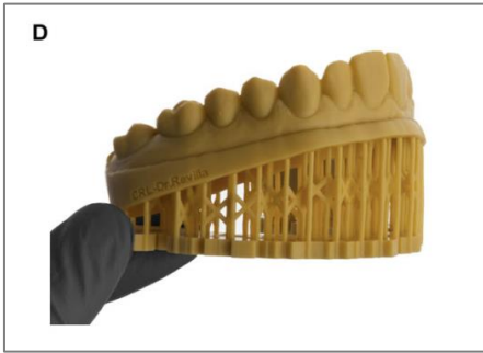
Resim 2.9. Eklemeli üretimde üretilecek objenin yapı platformuna tutunmasını sağlayan destek yapılar
