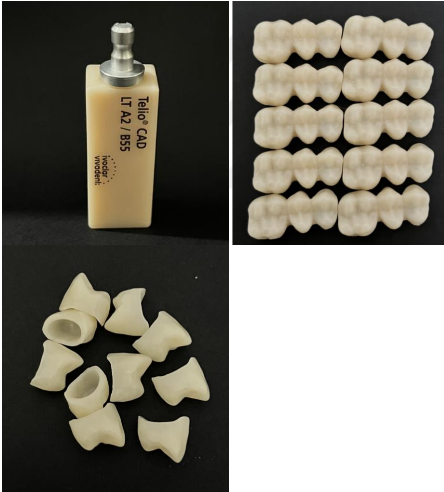
Resim 3.8. Prefabrike PMMA blok ve bloklardan elde edilen kron ve köprü restorasyonları
