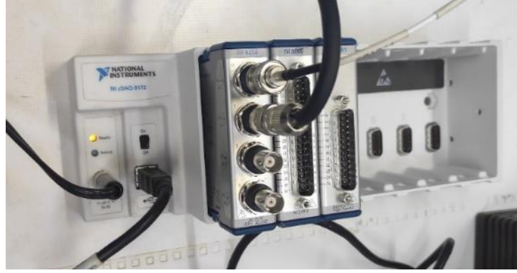
Şekil 5.18. Deneyleerde kullanılan NI 9234 ivmeölçer modülü
