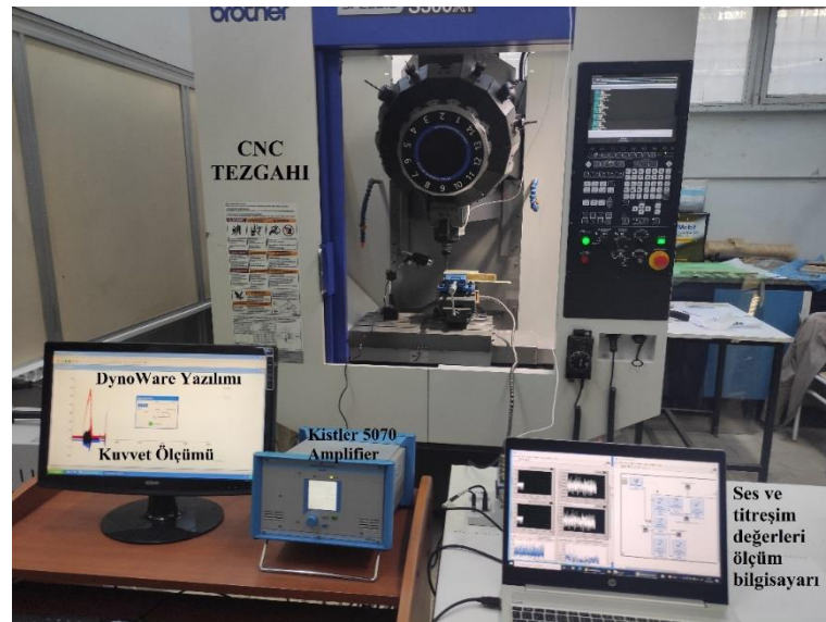
Şekil 5.16. Delme deneylerinin yapıldığı Brother Speedio S500X1 CNC tezgâhı
