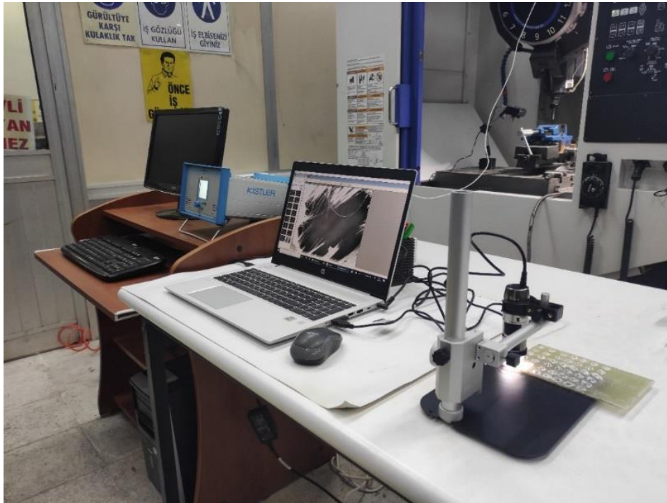
Şekil 5.19. Deformasyon görüntülerinin mikroskopla çekilerek bilgisayara aktarılması
