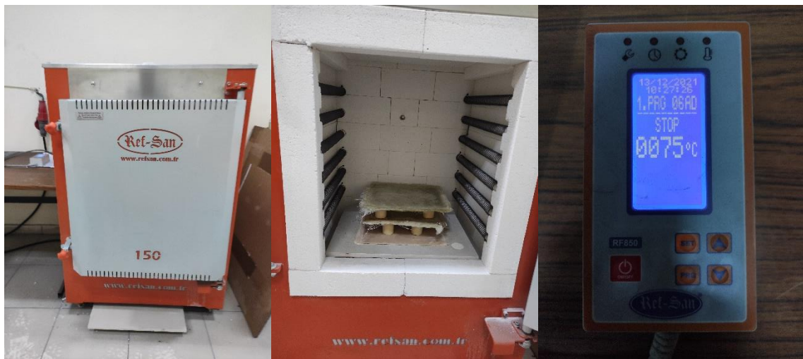
Şekil 5.5. Üretilen kompozit malzemenin fırınlanması
