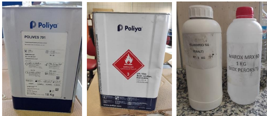
Şekil 5.2. Ticari olarak temin edilen vinilester, sertleştirici ve hızlandırıcı
