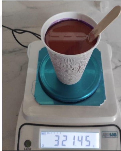
Şekil 5.3. Matris malzemesinin hassas terazide tartılması
