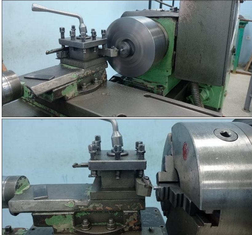
Şekil 5.9. Zımba olarak kullanılacak pistonların torna tezgâhında istenilen ölçüde kesilmesi
