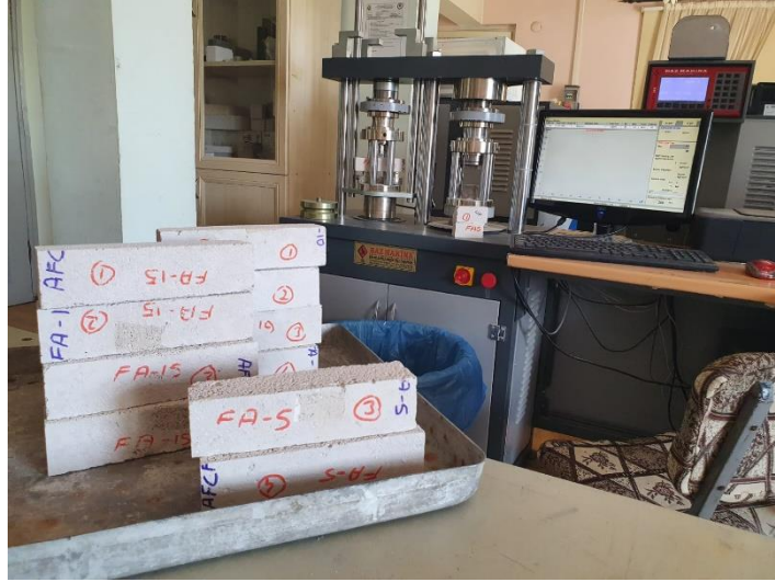
Şekil 3.12. Otoklavlanmış köpük beton numunelerinin eğilme ve basınç dayanımı deneyleri
