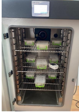
Şekil 3.16. Nem ve sıcaklık ayarlanabilen iklim kabininde su buharı difüzyon numuneleri
