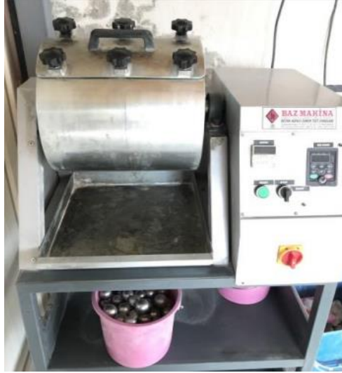
Şekil 3.1. Laboratuvar tipi bilyalı değirmen (SDÜ-DEYMAM)
