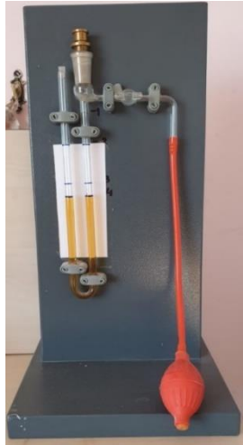
Şekil 3.4. Blaine test cihazı (SDÜ-DEYMAM)
