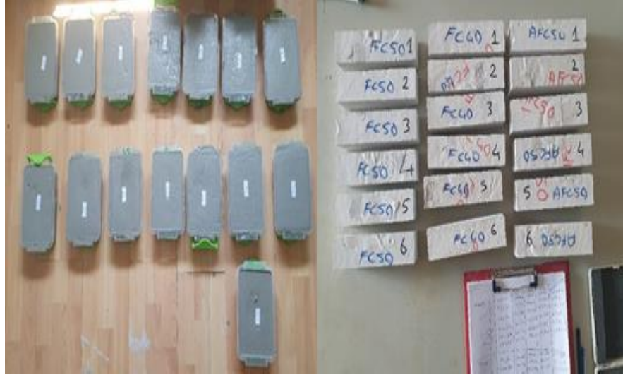
Şekil 3.8. Köpük beton deney numuneleri
