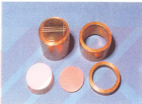
Resim 2.5. Yüzey sertliği testi için hazırlanmış metal model, ölçü malzemesi ve alçı model
