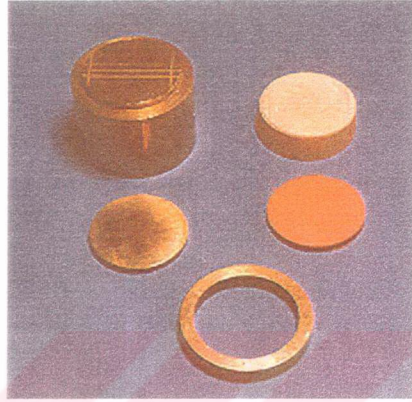
Resim 2.4. Çizgisel boyutsal sabitlik testleri için hazırlanmış metal model, ölçü malzemesi ve alçı model
