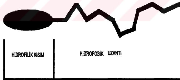
Şekil 1.3. Sürfaktan molekülünün genel yapısı (Myers, 1988)
