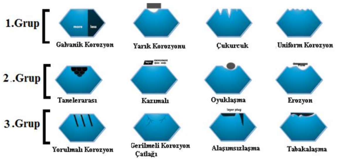
Şekil 2.6. Başlıca korozyon türleri (Noubissi vd. 2019)
