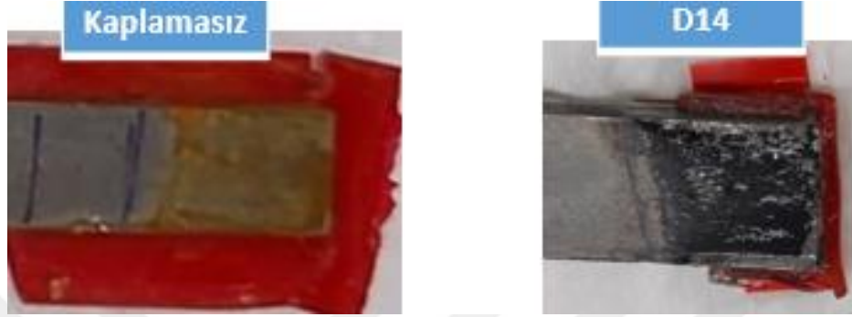
Şekil 4.71. Dört katman numunelerin elektrokimyasal ölçüm sonrası numune fotoğrafı
