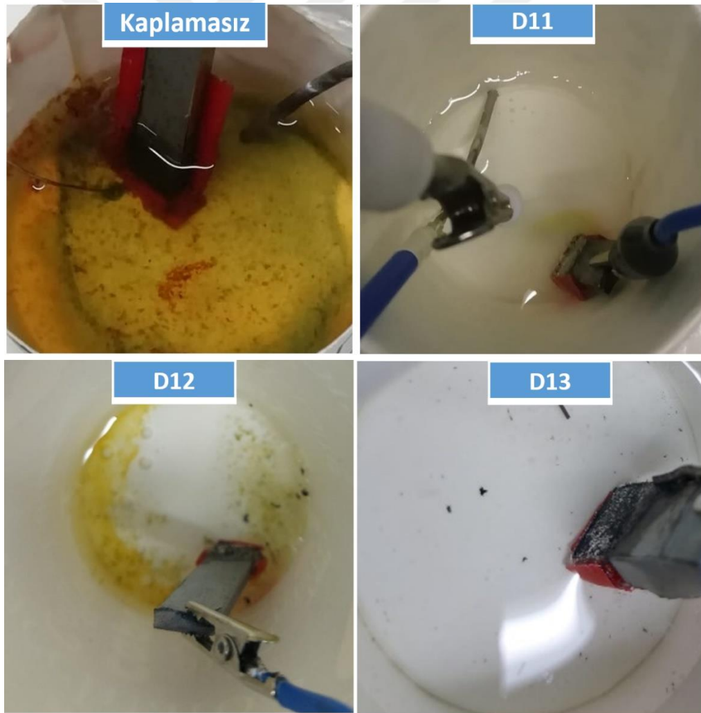
Şekil 4.55. Üç katman numunelerin elektrokimyasal ölçüm sonrası solüsyon
