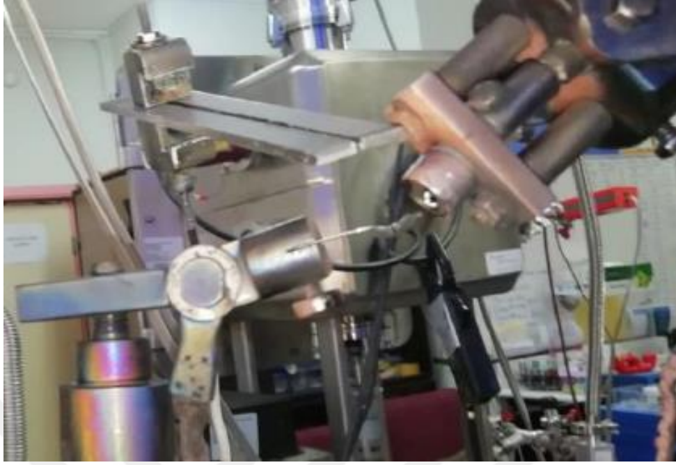
Şekil 3.9. TVA elektrotlarının düzeni
