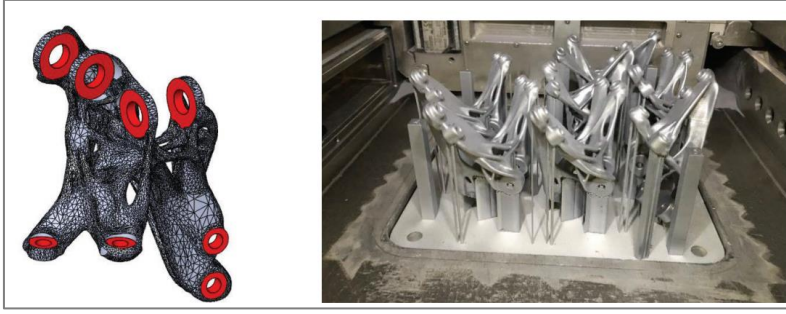
Şekil 2.18. Braketin fonksiyonel yüzeyleri ve üretilmiş numuneler [14]
