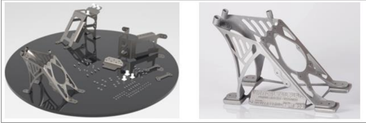
Şekil 2.23. Airbus A350 XWB kablo hattı komponenti [18]
