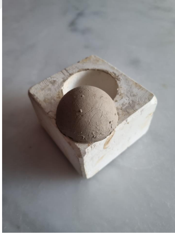
Resim 5.8: Alı Kalıptan ıkarılmış Kabara Formu.
