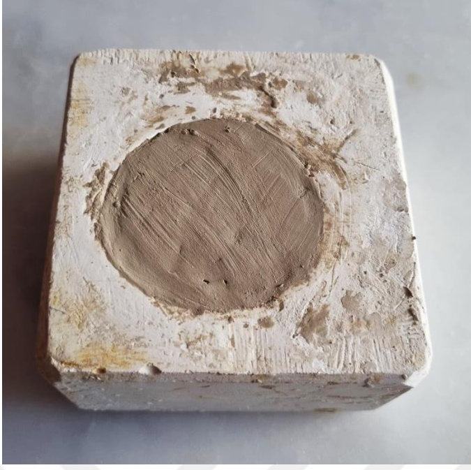
Resim 5.7: Kabara Formu İin amurun Alı Kalıba Basılması.
