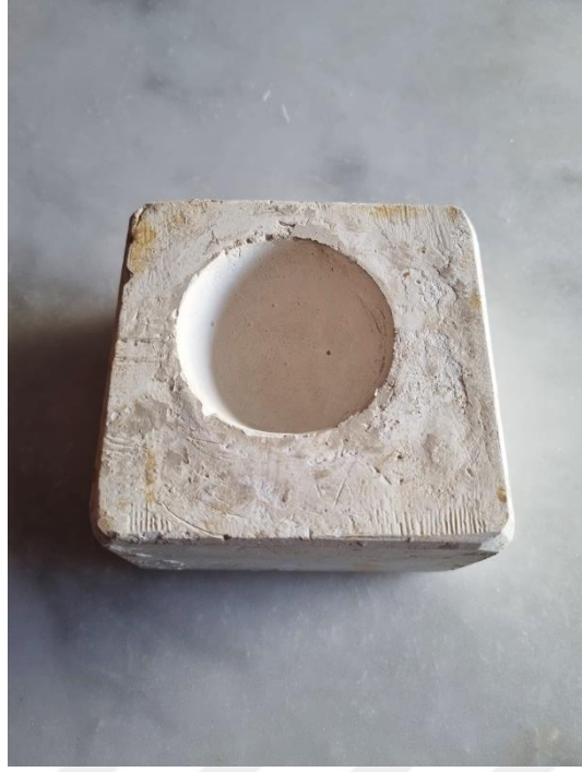
Resim 5.5: Kabara Formu İçin Hazırlanan Alçı Kalıp.
