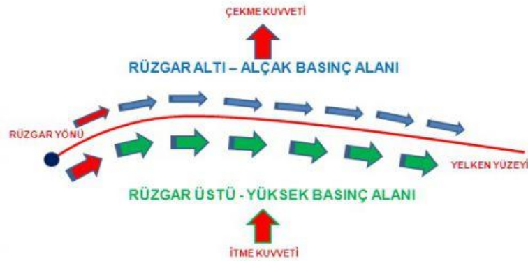
Şekil 1.2. Yelken hareket prensibi (www.kalyeta.com)
