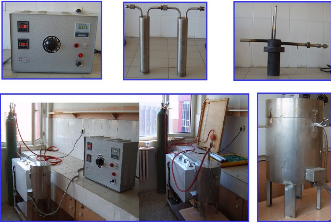
Şekil 3.1. Selçuk Üniversitesi Fen Fakültesi Kimya Bölümü piroliz deneylerinin gerçekleştirildiği sabit yataklı piroliz sistemi.
