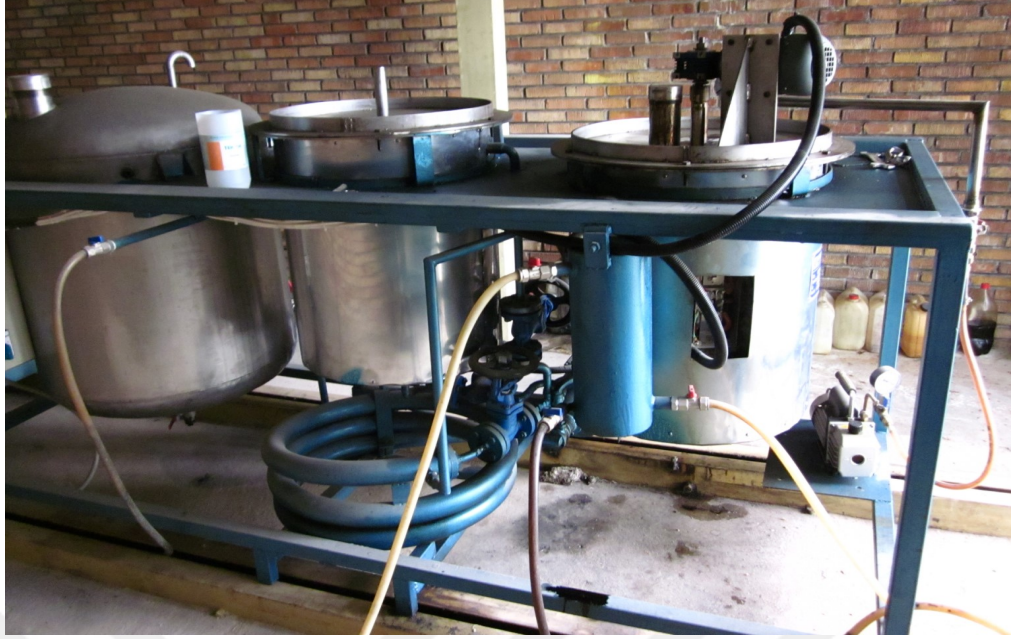
Şekil 3.2. Selçuk Üniversitesi Mühendislik-Mimarlık Fakültesi İnşaat Mühendisliği piroliz deneylerinin gerçekleştirildiği sabit yataklı piroliz sistemi.
