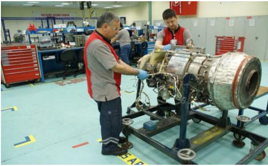
Şekil 27. APU Bakımı Yapan Teknisyenler
