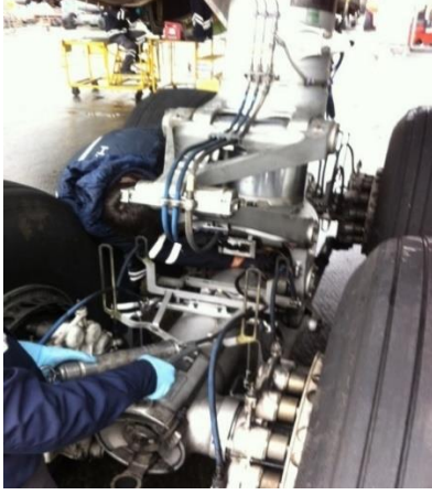
Şekil 76. İniş Takımı Yağlaması
