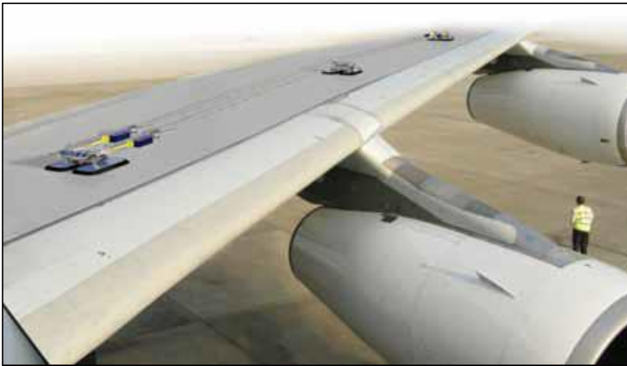
Şekil 38.Kanat Üzerinde Oluşturulmuş Mobilok İkiz Yaşam Hattı
