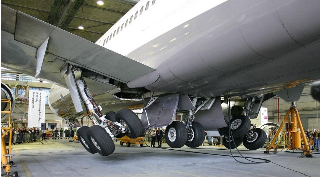
 ekil 45. Jack'a Alınmıř U a ın İniř Takımı Testi
