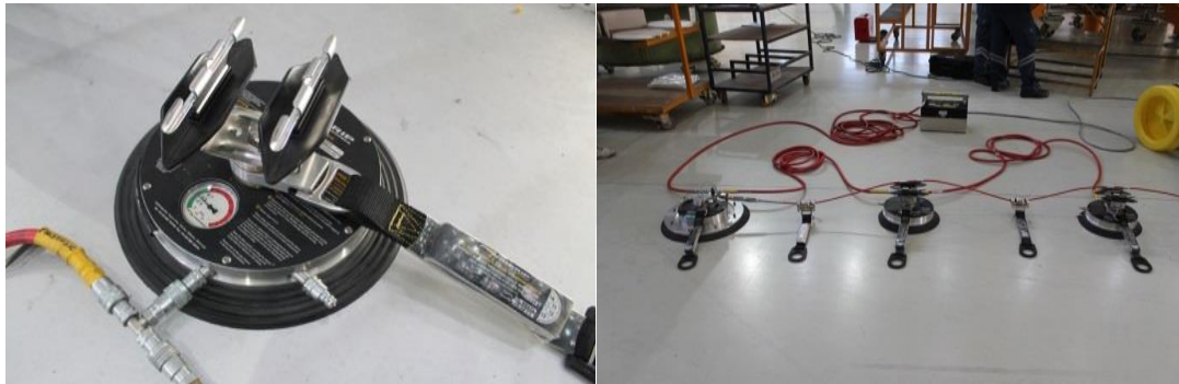
Şekil 33. Sisteme Ait Tüp Veya Harici Hava Kaynaklığıyla Kullanılan Wingrip Çapaları
