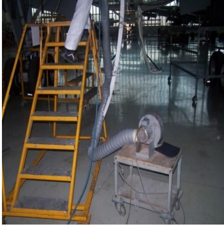
Şekil 39. Yakıt Tankı Havalandırması
