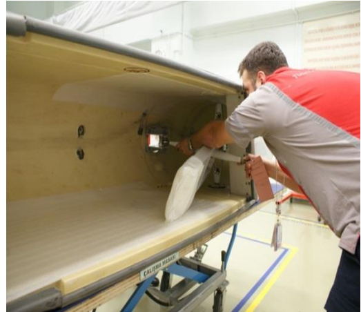
Şekil 16. Flap Fairing Tamiri
