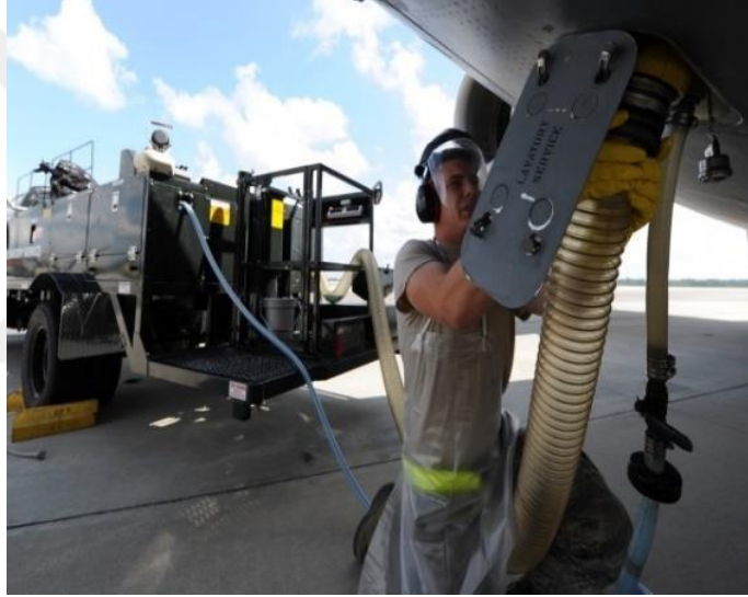
Şekil 42. Waste Tank Boşaltımı
