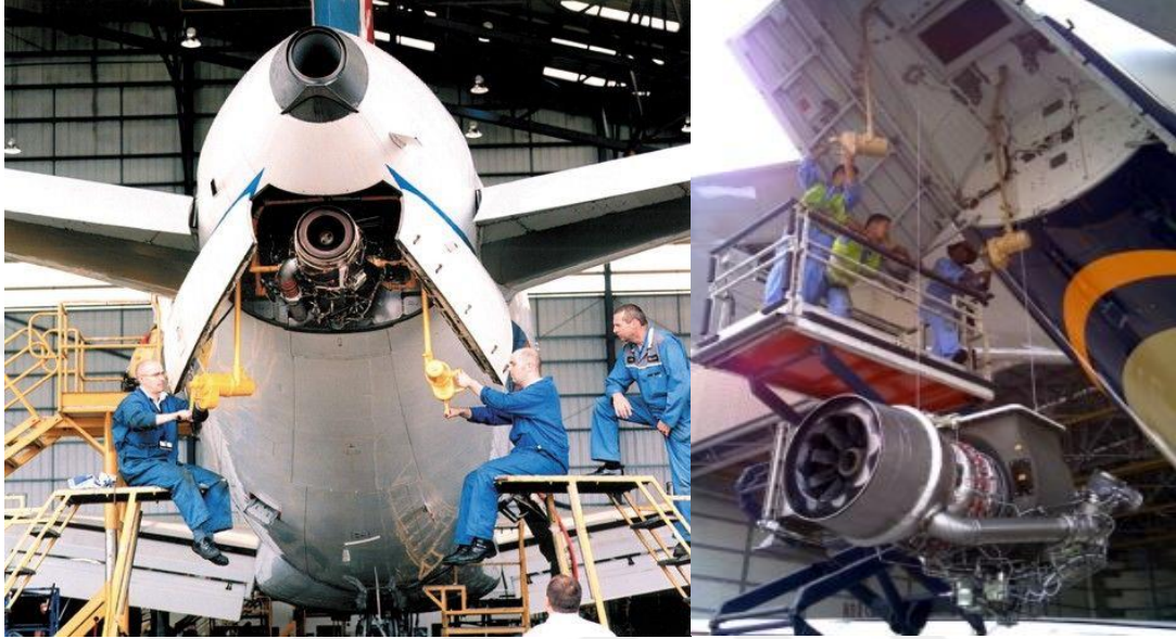
Şekil 46. Caraskal İle APU Söküm – Takımı Yapan Teknisyenler
