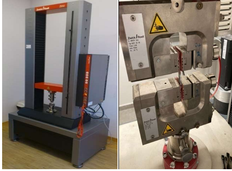
Şekil 4.7 Zwick Roell z050 ile yapılan çekme testi
