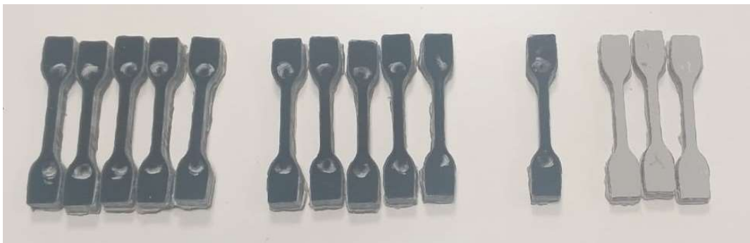
Şekil 5.9 Çekme testi için hazırlanan papyon kompozit numuneleri
