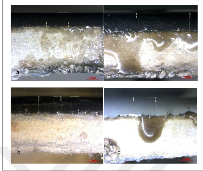
Şekil 5.18 Farklı oranda TDKNT ilaveli, betopan üzeri uygulanmış kompozit kaplamaların stereo mikroskop görüntüleri (sırasıyla %0.10 (a), 0.15 (b), 0.20 (c), 0.30 (d) KNT katkılı)
