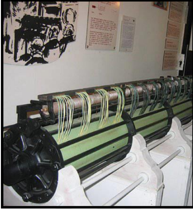
Resim1.3. Birkeland'in Norveç Teknik Müzesinde sergilenen bobinli elektromanyetik fırlatıcısı [11]
