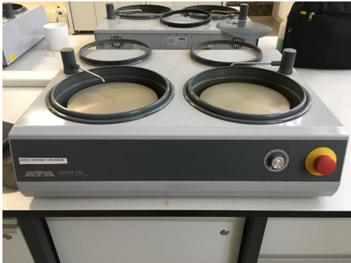
Resim 3.1. Zımpara ve polisaj cihazı ve kullanılan polisaj patı
