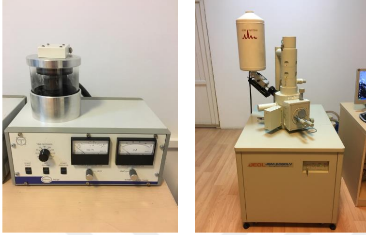
Resim 3.5. Örneklerin yüzey analizlerini yapmak için kullanılan yüzey kaplama cihazı Quorum SC7620 (İngiltere) ve scanning electron microscopy Jeol JSM-6060LV (Japonya)
