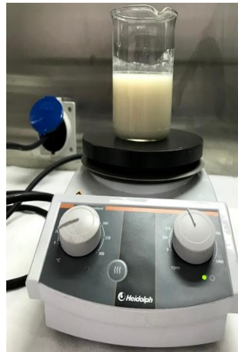
Şekil 3.6. Halloysit Nanotüp (HNT) dispersiyonu
