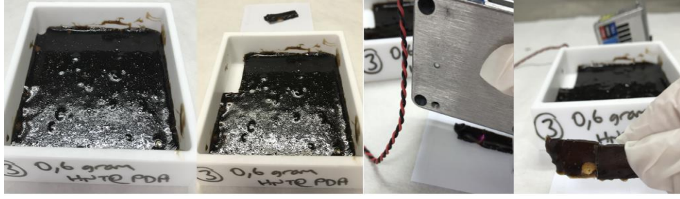
Şekil 4.27. 0.6 gram HNT@Polidopamin içeren nanokompozit hidrojelin NIR ışık ile kendi kendini onarımı
