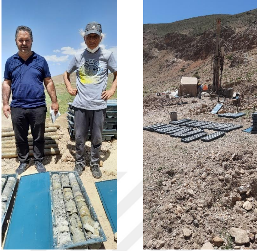
Şekil 3.3 Arazide hidrolik sondaj makinası ile alınan karot numuneleri
