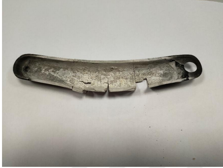
Şekil 3.5 Yüksek sıcaklık aktivasyon deneylerinde yapısal bozulma olan seramik küvet
