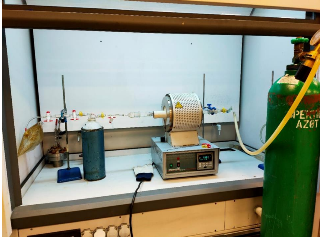
Şekil 3.4 Ön karbonizasyon ve aktivasyon işlemleri için kurulan piroliz düzeneği
