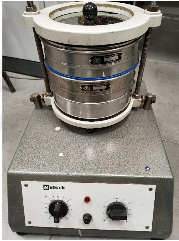
Şekil 3.3 Homojenize edilmiş biyokütleler için kullanılan titreşimli elek sallayıcı
