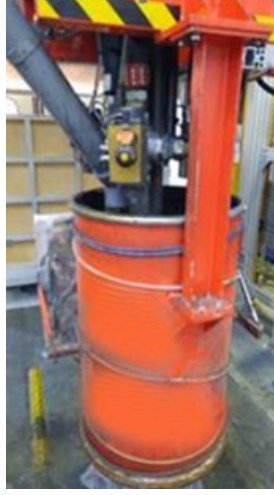
Şekil 3.3. İzosiyanat, poliöl, katalizör ve grafitin mikser ile karıştırılması
