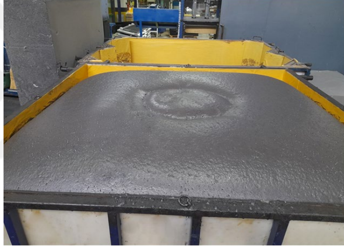
Şekil 3.4. Kasa içerisinde PU esaslı köpük üretimi
