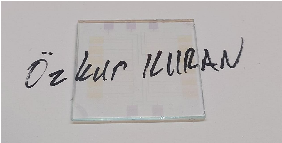
Şekil 5.66 Tüm aşamaları tamamlanmış ve üzerine 5. katman olarak IGZO yarıiletkeni korumak için \text{SiO}_x kaplaması yapılmış tamamen transparan ince film transistör
