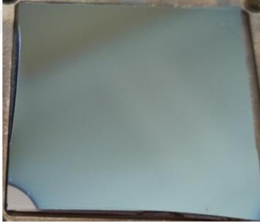
Şekil 5.33 SiOx ince filmi kaplandığı kalınlığa göre farklı renklerde görünmektedir.
