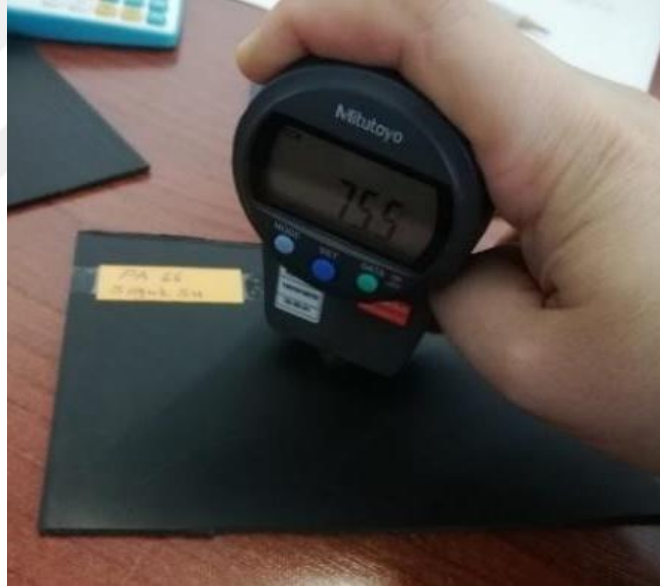
Şekil 3.8 : %30 cam elyaf takviyeli PA66 levhannın sertlik ölçümü.
