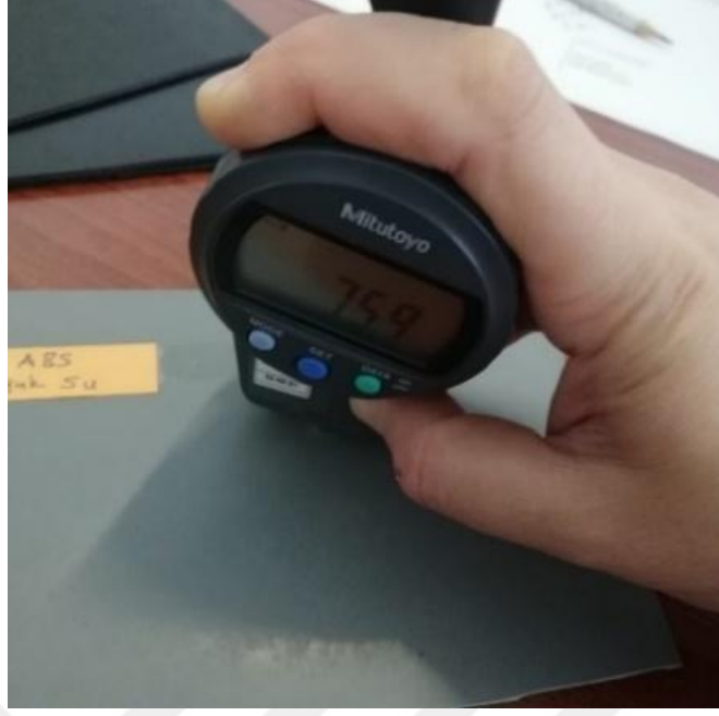
Şekil 3.7 : ABS levhannın sertlik ölçümü.
