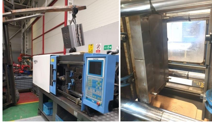
Şekil 3.2 : Kalıbın enjeksiyon makinesine bağlanması.
