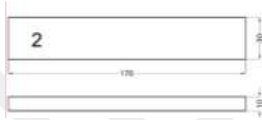
Şekil 3.3. Çekme testi numune boyutları
