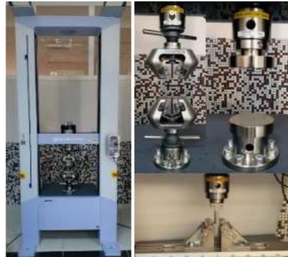
Şekil 3.2. (1) Isıl iletkenlik testi numune boyutları, Resim 3.8. Shimadzu AGS-X 100 kN üniversal basma ve çekme test cihazları (Akdoğan, 2019) (2) Basma testi numune boyutları
