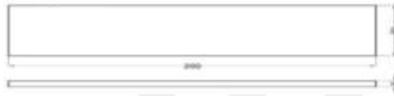
Şekil 3.1. Eğilme testi numune boyutları
