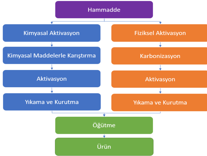
Şekil 2.4. Aktif karbon üretim şeması
