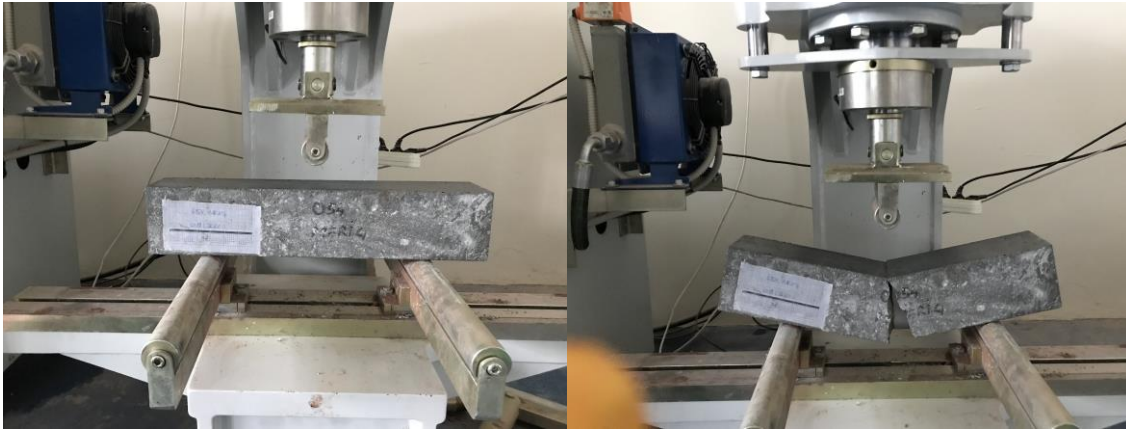
Resim 4.5. Kiriş numunelerin eğilmede çekme dayanımı deneyi
