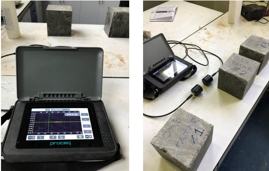
Resim 4.6. Ultrasonik dalga geçiş hızı tayini deneyi
