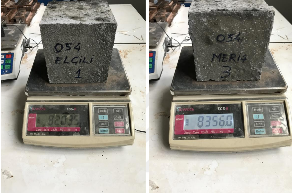
Resim 4.2. Sertleşmiş beton birim ağırlık tayini
