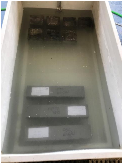
Resim 4.3. 28 günlük suya doymun ağırlık ve etüv kurusu ağırlık deneyi
