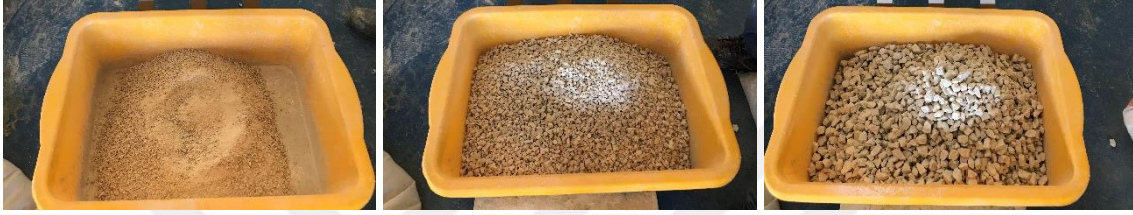
Resim 3.3. Taş tozu, Kırmataş I ve Kırmataş II agregaları
