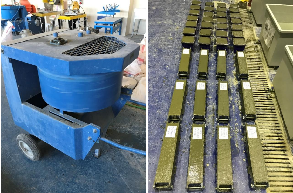
Resim 3.10. Karışımlarda kullanılan mikser ve dökümü yapılan numuneler
