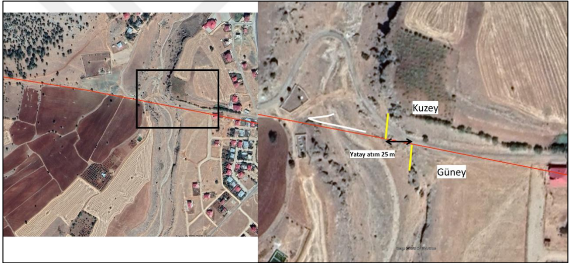
Şekil 5.20. Çardak Fayı'nın Barış Mahallesi civarında gözlenen alüvyon yelpazesinde meydana getirdiği yatay atımın Google Earth görüntüsü.
