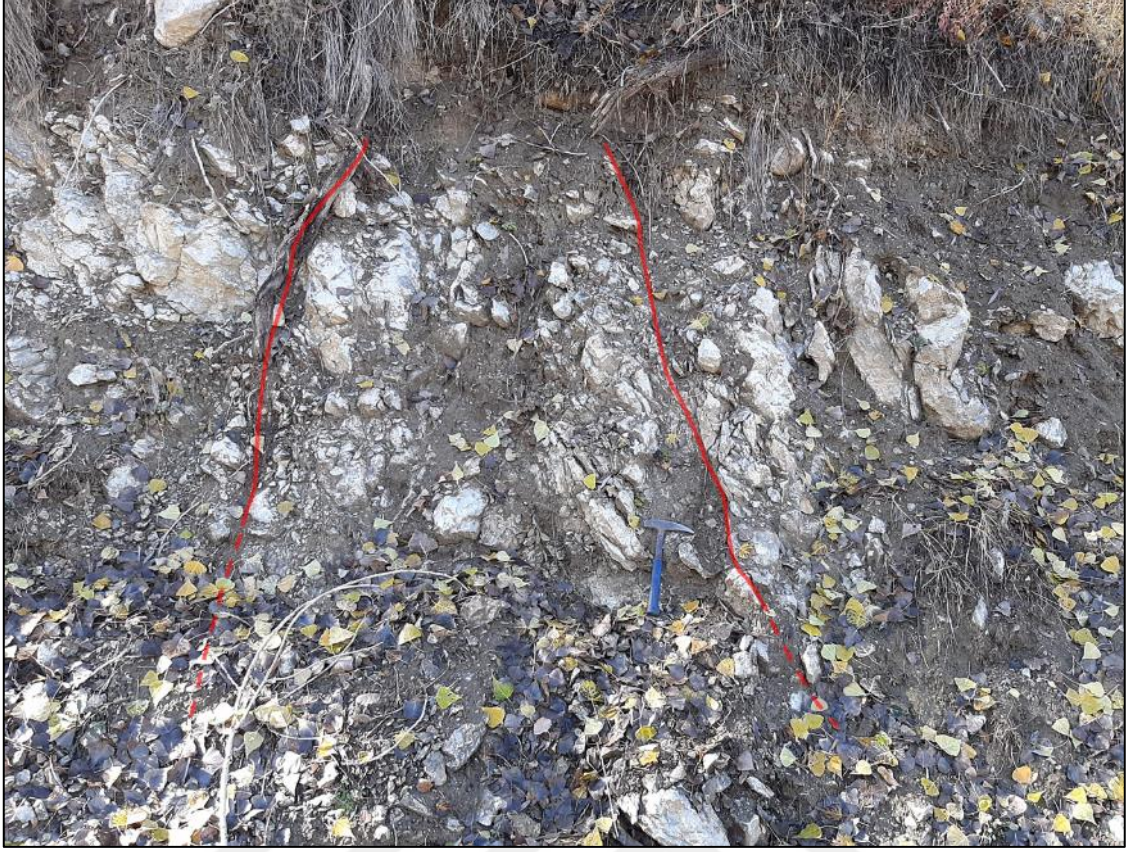
Şekil 5.11. Alıçlı Formasyonu rekristalize kireçtaşları içerisinde gözlenen, ana fay düzlemi ile aynı doğrultuda olan faylanmalar
