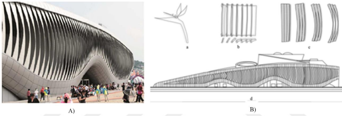
Şekil 2.5. A. Tematik Üst Örtü, Expo 2012, Yeosu Kore (Barozzi ve diğ., 2016), B. (a) Cennet Kuşu çiçeği, (b) temel Flectofin prensibi, (c) Flectofin panjurlarının projelendirilmesi ve (d) Lamella cephesi-kapalıdan 60 ° açıklığa hareket (Megahed, 2016).
