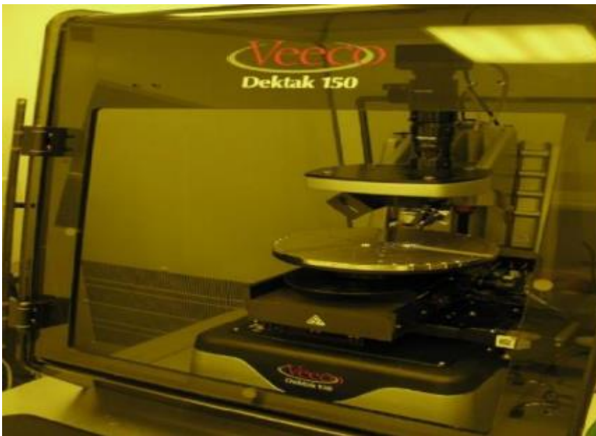
Resim 3.6. “Veeco Dektak-150” profilometre
