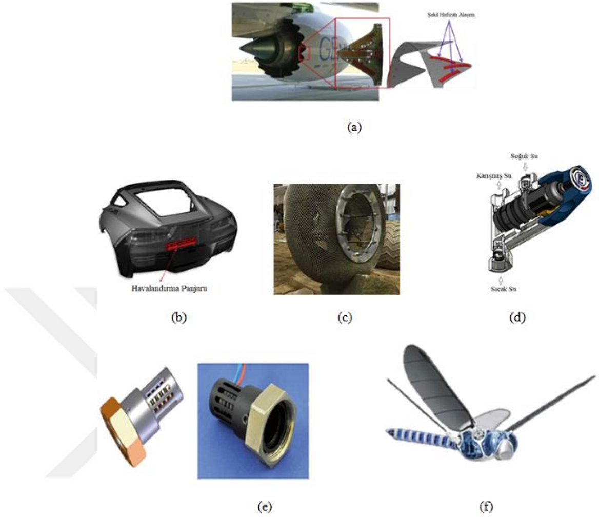
Şekil 2.20 Şekil hafızalı alaşımların çeşitli uygulamaları : (a) Boeing değişen geometrili chevron uygulaması (Arun et al. , 2018) (b) otomobillerde havalandırma panjuru uygulaması (Mohd Jani et al. , 2014) (c) NASA'nın NiTi esnek tekerleği (The Register, 2020) (d) Mini termostat uygulaması (Czechowicz and Langbein, 2015) (e) Valf uygulamalarında kullanılan şekil hafızalı alaşım aktüatörleri (Czechowicz and Langbein, 2015) (f) Robot Sinek (BionicOpter) (Arun et al. , 2018)
