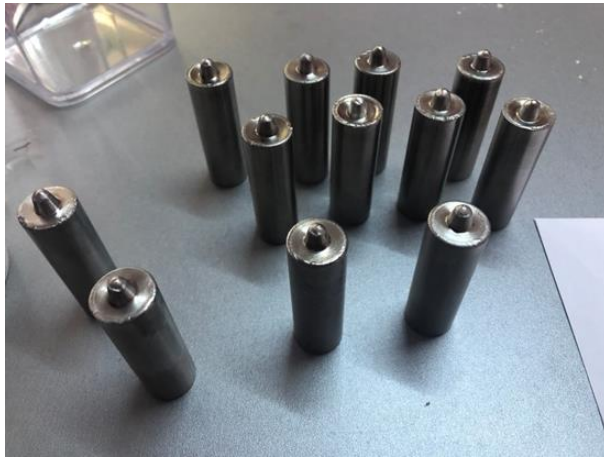
Şekil 3.3 Elektron ışın kaynağı ile kapatılmış kapsüller
