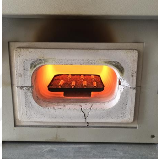
Şekil 3.7 Kül fırınında gerçekleştirilen homojenleştirme ısıt işlemleri
