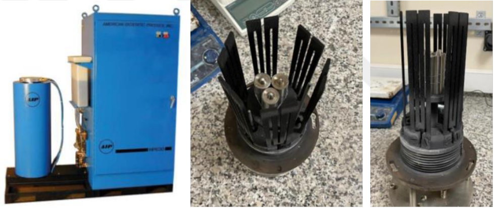
Şekil 3.4 Sıcak izostatik pres cihazı ve proses görüntüleri
