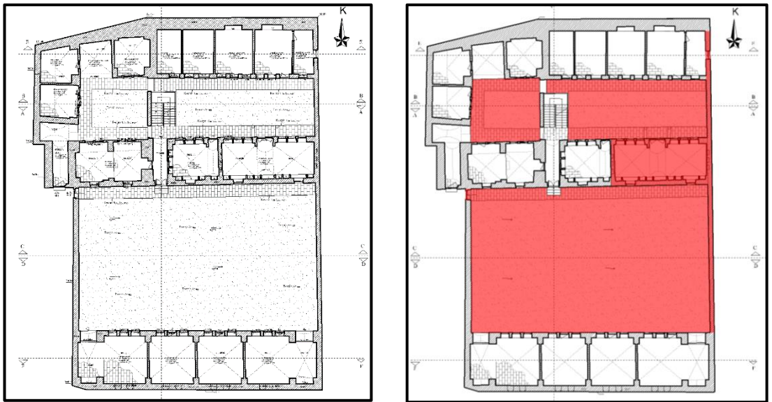
Şekil 4.89 İkinci dönem restitüsyonunda zemin kat planında yapının Şanlıurfa evi olduğu dönemde de var olduğu tespit edilen bölümler (kırmızı ile gösterilmiştir) (Yazar arşivi, 2022).
