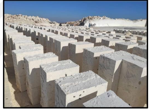
Şekil 3.36 Günümüz teknolojisi ile taş ocağından çıkarılmış kalker taşı blokları, (Yazar arşivi, 2021)
