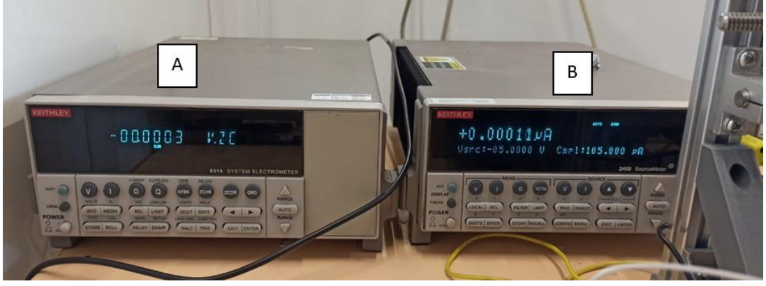
Şekil 25 : Elektriksel ölçümlerde kullanılan cihazlar. A)Keithley 6514 System Elektrometre, B)Keithley 2400 Kaynak Ölçer.
