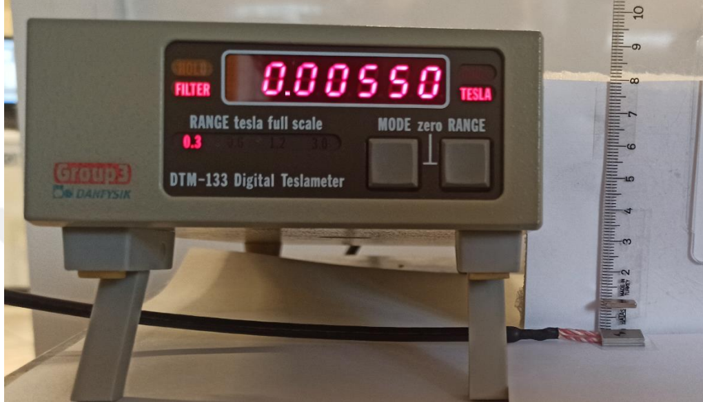
Şekil 27 : DC manyetik alan ile ölçümlerde kullanılan mıknatısın 1 cm mesafedeki manyetik alan değeri.
