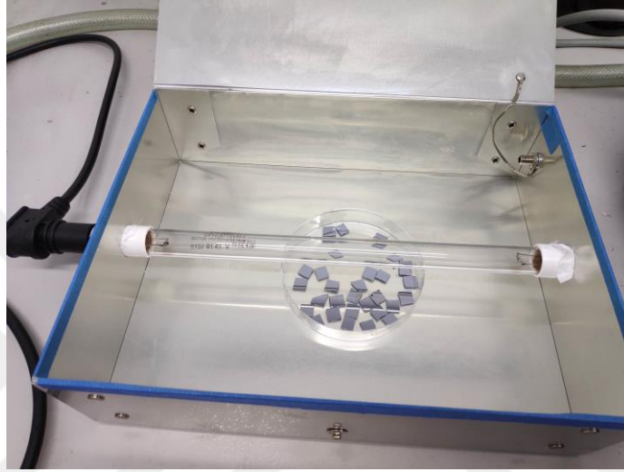
Şekil 2.16. UV-Ozon cihazına yerleştirilen altlıklar
