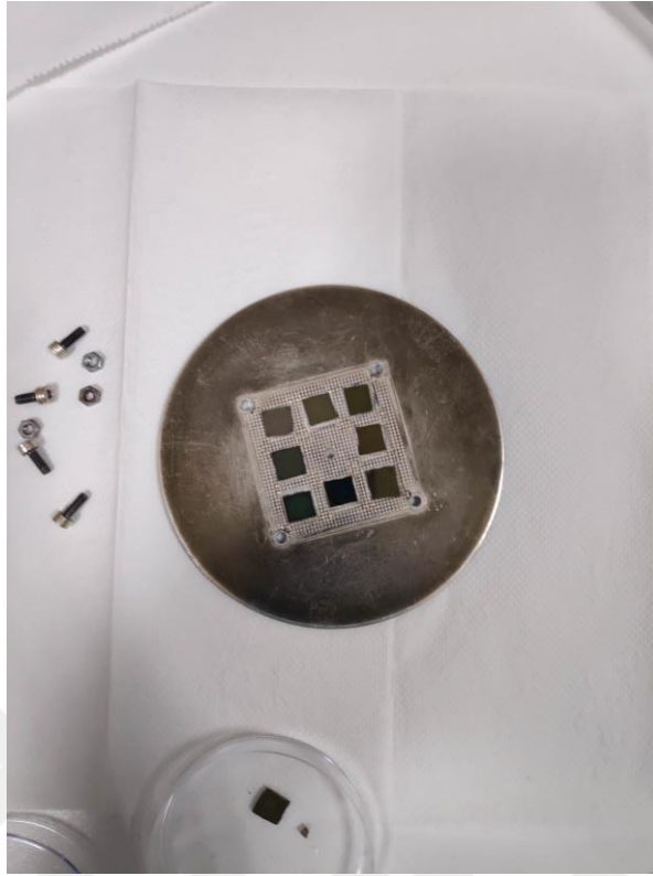
Şekil 2.20. PVD işlemi için numunelerin holdere yerleştirilmesi
