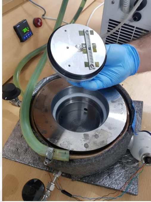
Şekil 2.19. Numunelerin skCO 2 tavlama için basınçlı CO 2 hücresine yerleştirilmesi
