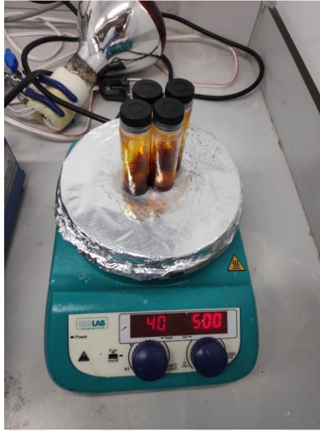
Şekil 2.14. Manyetik karıştırıcıda karıştırılan P3HT: PCBM çözeltileri
