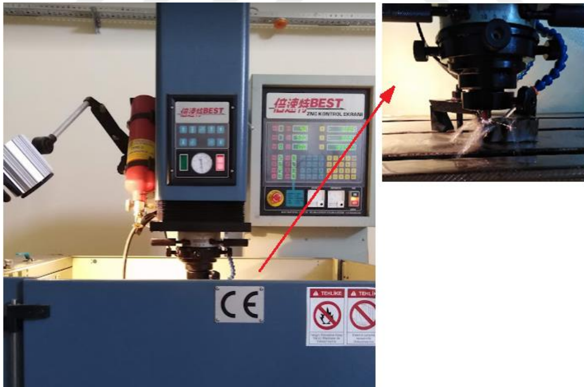
Şekil 5.4. ZNC Best-3000S dalma erozyon tezgâhı
