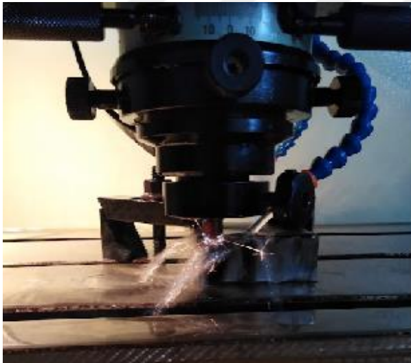
Şekil 5.5. İşleme esnasında püskürtülen dielektrik sıvısı
