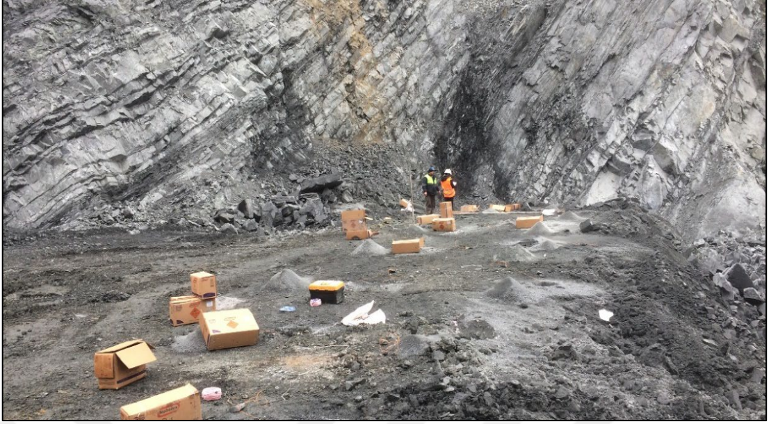
Şekil 3.4: Agregra ocağında sıkılama işlemi.
