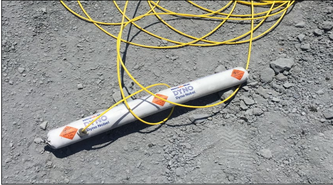
Şekil 3.2: Powermite kapsüle duyarlı emülsiyon patlayıcı.
