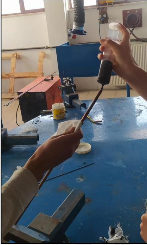
Resim 7.4. Isı borusuna nanoakışkan eklenmesi
