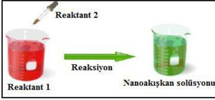
Şekil 5.2. Tek adım yöntemiyle nanoakışkan hazırlama işlemi [59]
