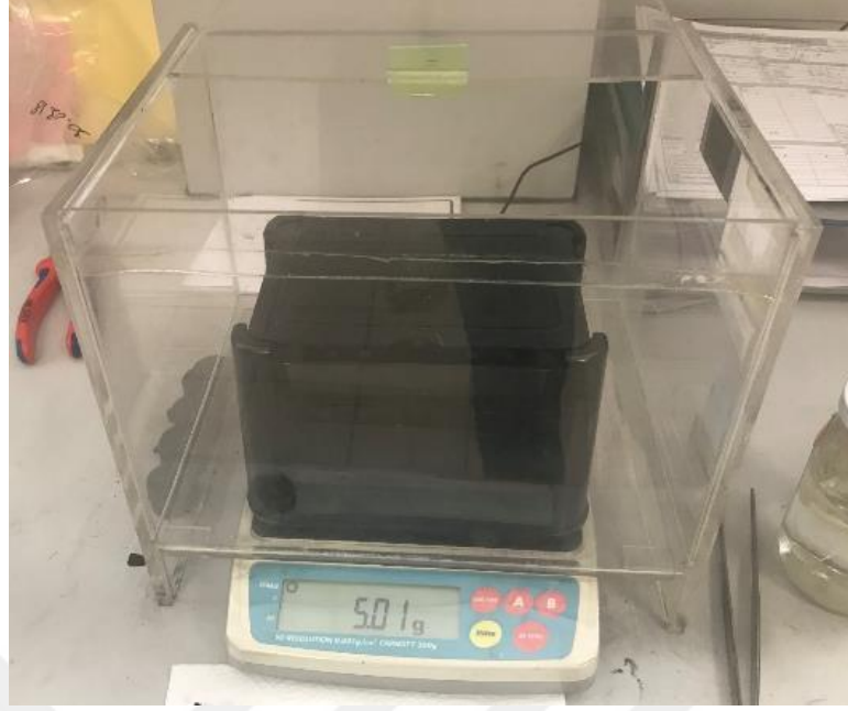
Şekil 3.4 Yapılan Yoğunluk Ölçümüne Ait Bir Örnek
