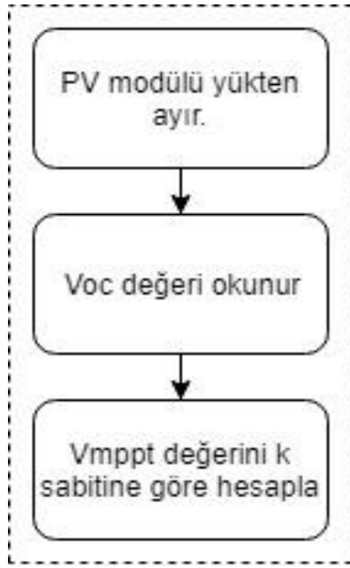
Şekil 2.15. Sabit gerilim metodu akış diyagramı
