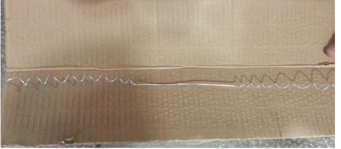
Şekil 3.14. Isı transfer iyileştirme elemanı
