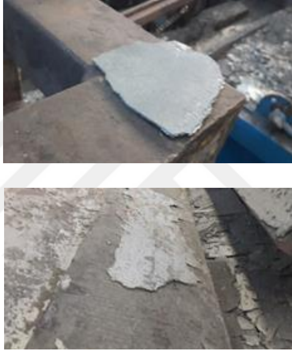
Şekil 2.1 Oksitlenme sonucu kütük yüzeyinde oluşan tufal tabakası
