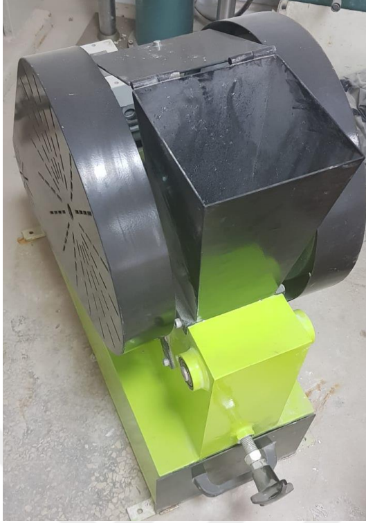
Şekil 3.6. Sert küresel uçucu kül peletlerinin kırılması için kullanılan kırıcı
