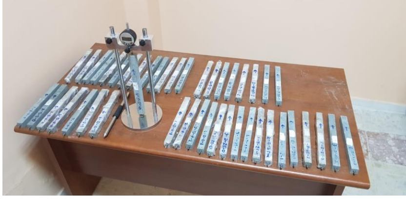
Şekil 3.17. Kuruma ve ötojen rötre numuneleri
