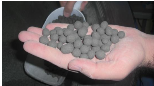
Şekil 3.5. Sıkışmış ve sert küresel uçucu kül peletleri
