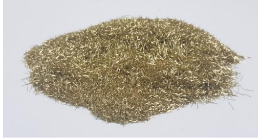
Şekil 3.8. Harç karışımlarında kullanılan mikro çelik lif
