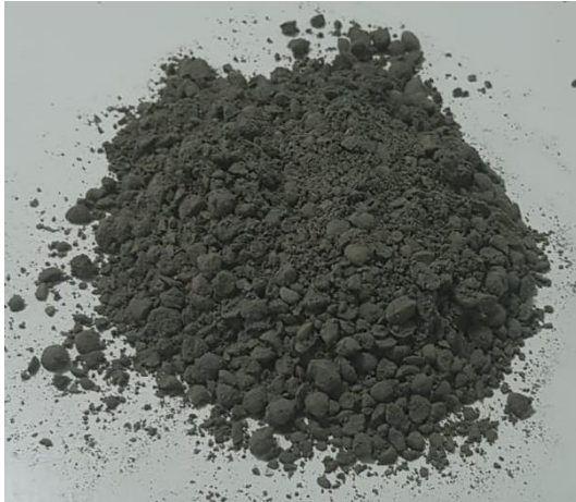
Şekil 3.7. Kırılmış ve elenmiş sert küresel uçucu kül taneleri
