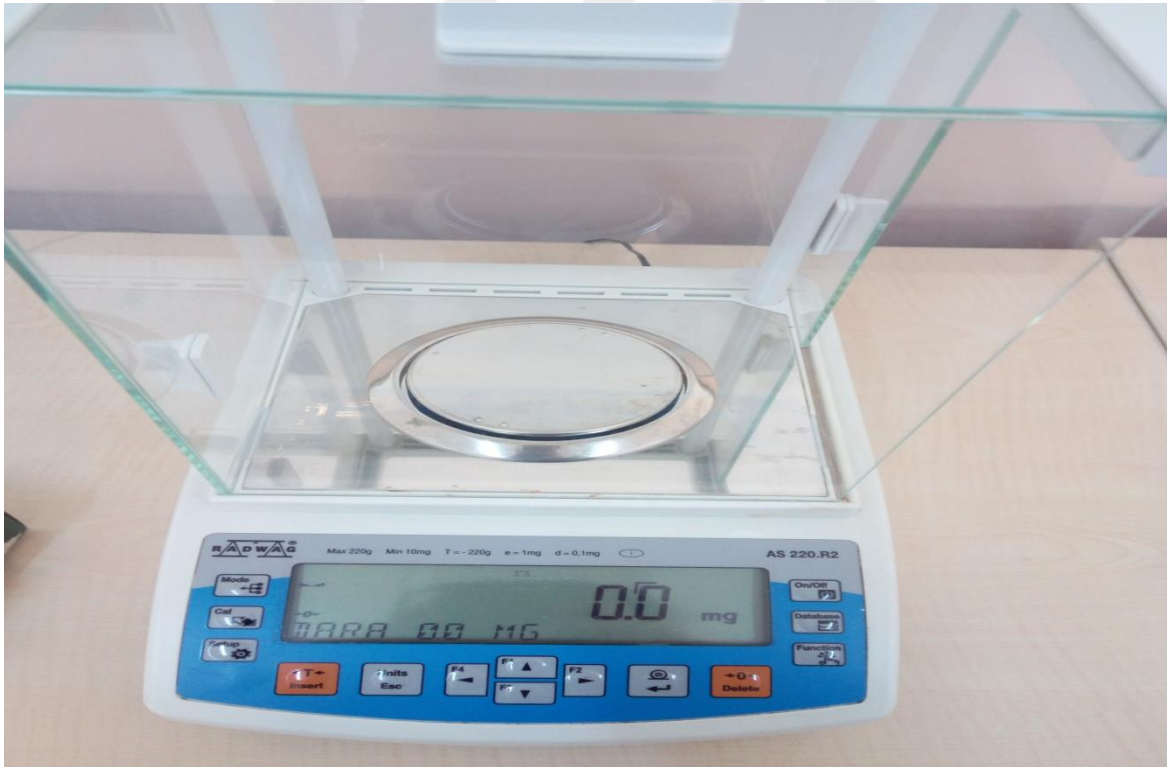
Resim 5.1. Adsorbentlerin ölçümünde kullanılan hassas terazi
