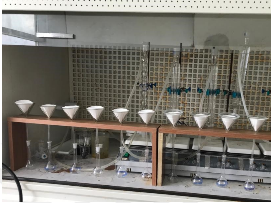
Şekil 3.2. Yakılan gıda örneklerinin süzme işlemi görüntüsü
