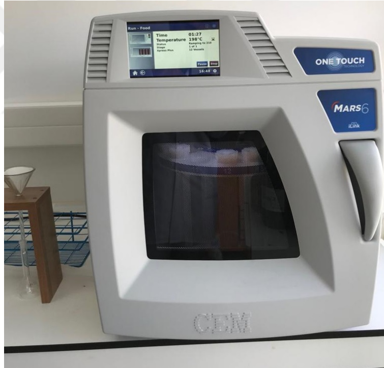
Şekil 3.1. CEM marka Mars6 model yakma ünitesinin görüntüsü
