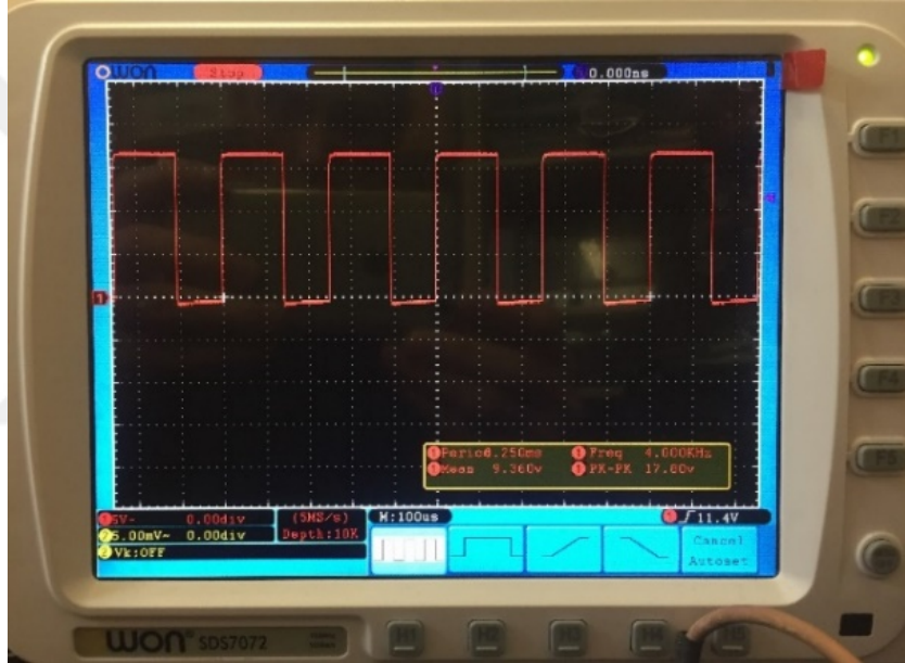
Resim 4.9 Çift yönlü dönüştürücünün alçaltıcı olarak çalışması sırasında kullanılan DGM sinyali.
