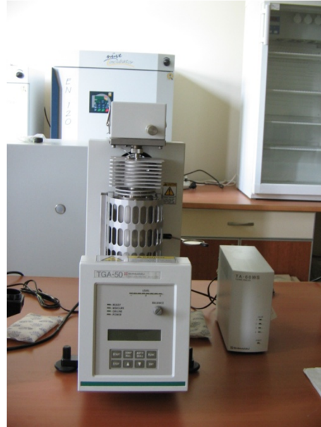
Şekil 3.17. Thermogravimetric Analiz (TGA) Analizörü
