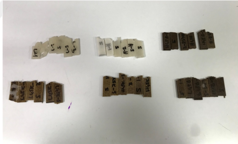
Şekil 3.15. Sıvı azotta bekletilen deney numunelerinin darbe testi sonrasında kristal yüzey elde edilmesi
