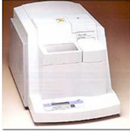
Şekil 3.18. Diferansiyel Taramalı Kalorimetri (DSC) Analizörü
