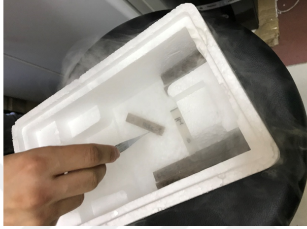
Şekil 3.14. Sıvı azotta bekletilen deney numuneleri
