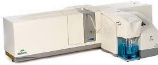
Şekil 4.1. Malvern Mastersizer 2000 MU tane boyut cihazı.
