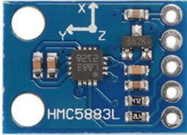
Şekil 3.4. Aktivite tanıma kullanılan X, Y, Z üç eksende manyetik alan ölçümü yapabilen HMC5883L pusula
