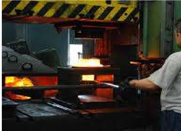
Şekil 4.7: Sıcak dövme işlemi.
