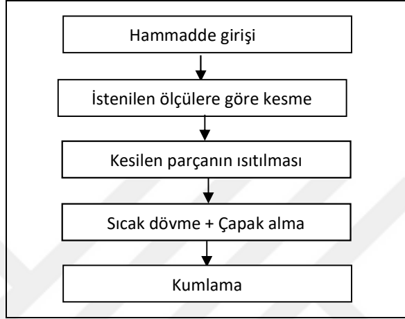
Şekil 4.6: Dövmehane iş akım şeması.
